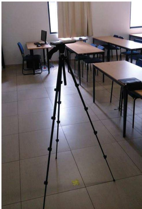
*Figura 35.* Sonómetro colocado en la posición 1, cuarto receptor.
