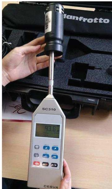
*Figura 33.* Calibración el sonómetro.
