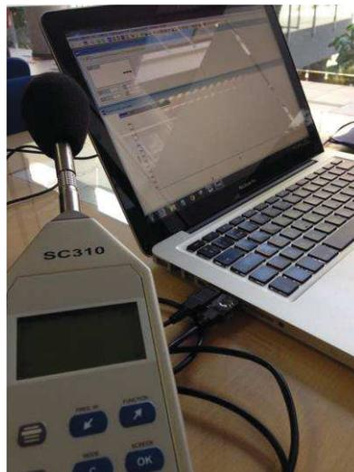
*Figura 48.* Conexión por medio USB de un sonómetro.
