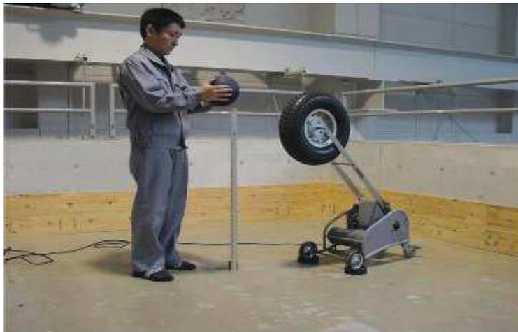
*Figura 10.* La bola de caucho y la máquina de explosión usadas en Japón.
