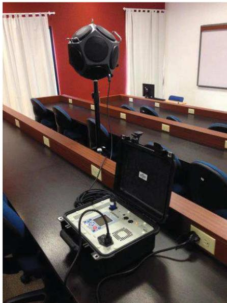
*Figura 39.* Fuente omnidireccional ubicada en posición de medición.
