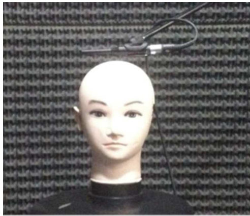
Figura 37. Ubicación del micrófono de medición para ecualizar la sala.
