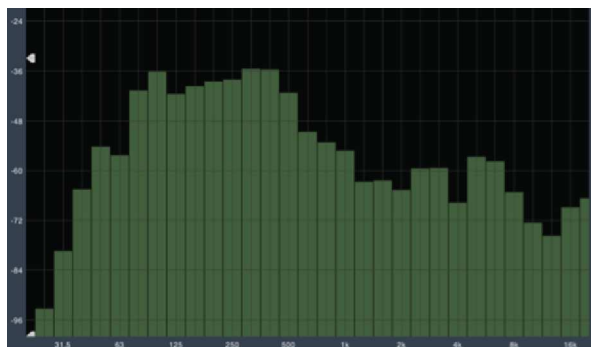
Figura 40. Espectro de frecuencia obtenido al medir aislamiento dentro de la cabeza de un maniquí utilizando los auriculares Sennheiser HD 280.
