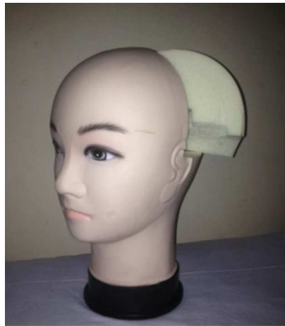
Figura 29. Cabeza de maniquí con relleno de poliuretano de alta densidad.
