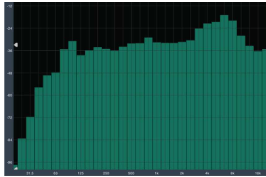
Figura 39. Espectro de frecuencia medido con micrófono de medición ubicado dentro de la oreja del maniquí.
