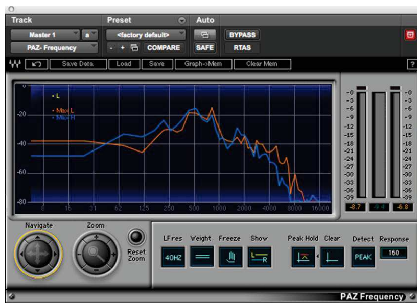
Figura 52. Respuesta de frecuencia del punto de medición número dos a 14.02 [m] de la fuente en el Teatro Lalama.
