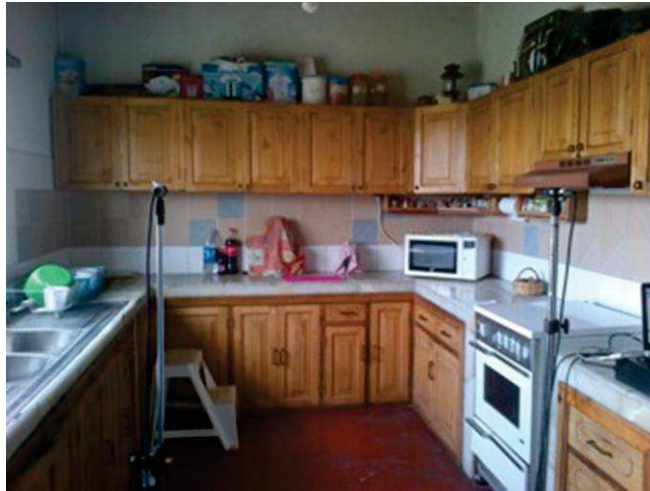
Figura 17. Ubicación del punto de medición y la parte frontal de la cocina donde se ubicó a la fuente impulsiva (globo).
