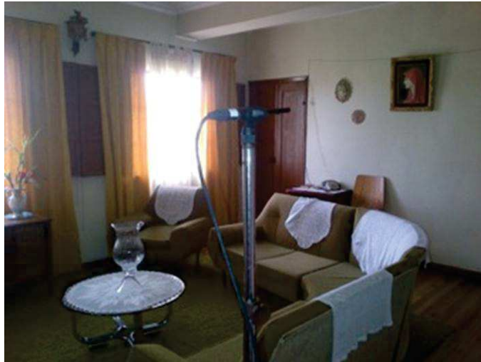
Figura 20. Ubicación del punto de medición y la parte frontal de la sala donde se ubicó a la fuente impulsiva (globo).
