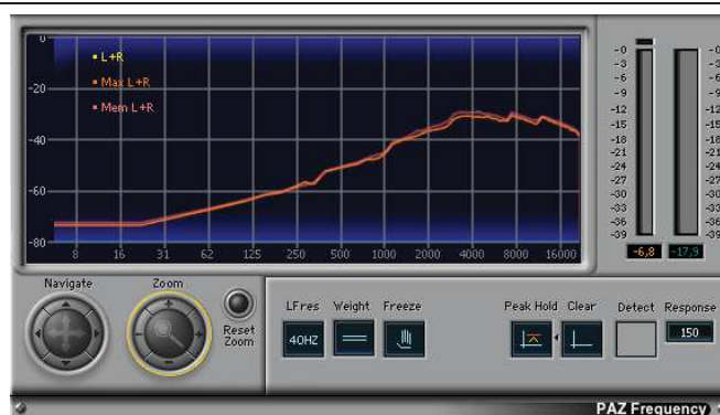
Figura 82. Respuesta en frecuencia del ecualizador para el potenciómetro de 22k \Omega en el preamplificador Marshall JCM800.
