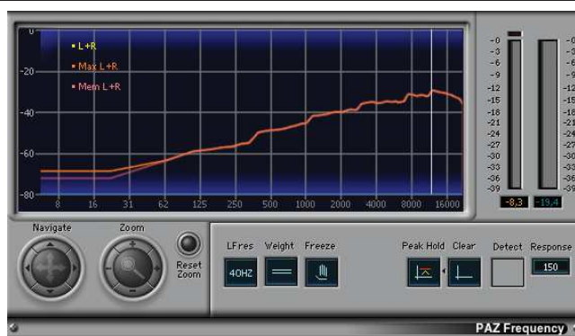
Figura 80. Respuesta en frecuencia del ecualizador para el potenciómetro de 1M \Omega en el preamplificador Fender Champ 5E1.
