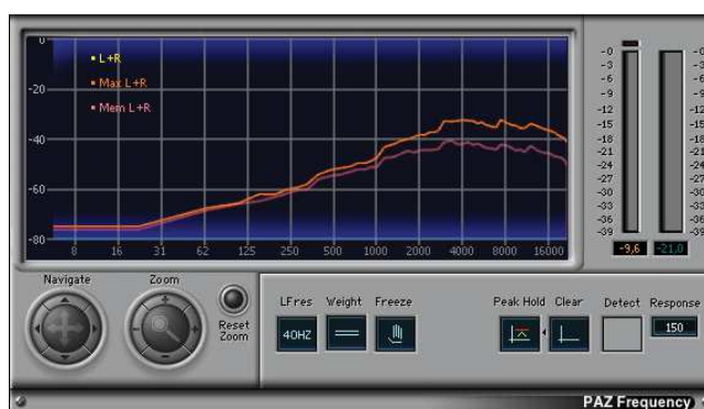
Figura 81. Respuesta en frecuencia del ecualizador para el potenciómetro de 250k \Omega en el preamplificador Marshall JCM800.
