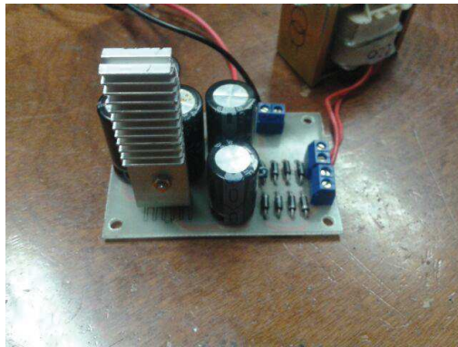
Figura 68. Placa etapa de rectificación soldada.
