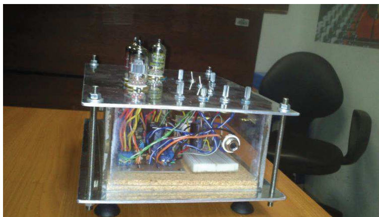
Figura 113. Preamplificador construido vista lateral.
