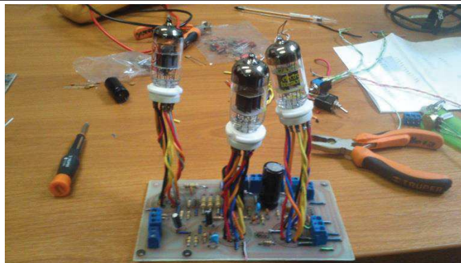
Figura 69. Placa etapa de amplificación soldada.
