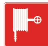
Manquera para incendios
