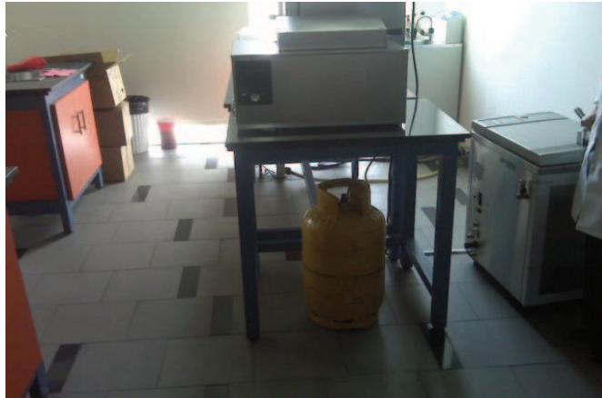
Figura 3.19 Tanque de gas mal ubicado laboratorio Microbiología
