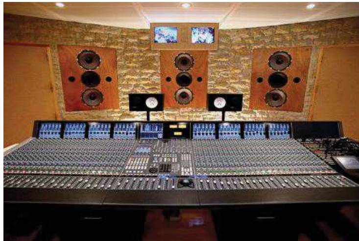
Figura 11. Monitoreo de campo cercano y campo lejano en estudio de grabación. Tomado de Tucamon. http://www.tucamon.es/photos/0000/7207/im1blog.jpg?1229031364 .
