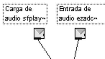
Figura 4.2: Entradas tipo inlet/outlet para conectar la entrada de audio por micrófono, línea o carga directa de archivos en el computador; con las estructuras superiores del programa.
