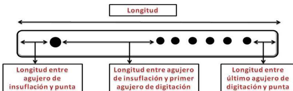
Gráfico 3.6. Gráfico descriptivo de las longitudes de la flauta transversa de carrizo.
