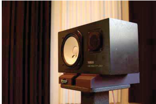
Figura 9.3: Ejemplo un altavoz sobre 2 MoPad y una columna de madera.
