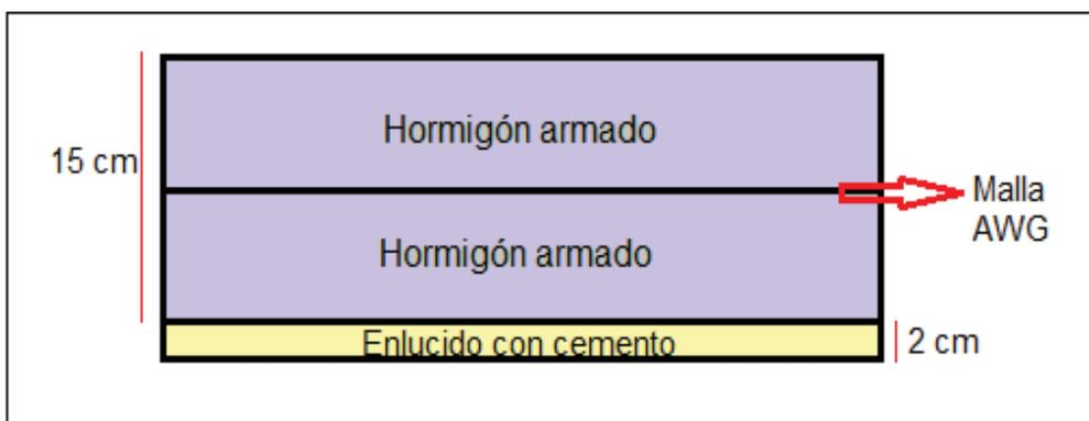
Como se observa en la figura 4.18 se diseñó una estructura de techo básica ya que las paredes y suelo ya llevan un adecuado aislamiento acústico y la idea de las salas es tener una estructura sólida pero liviana para evitar cualquier tipo de fallas en la obra gris. El techo estará con enlucido de cemento y pintado, estéticamente se pensó en acabados de mármol o madera.
