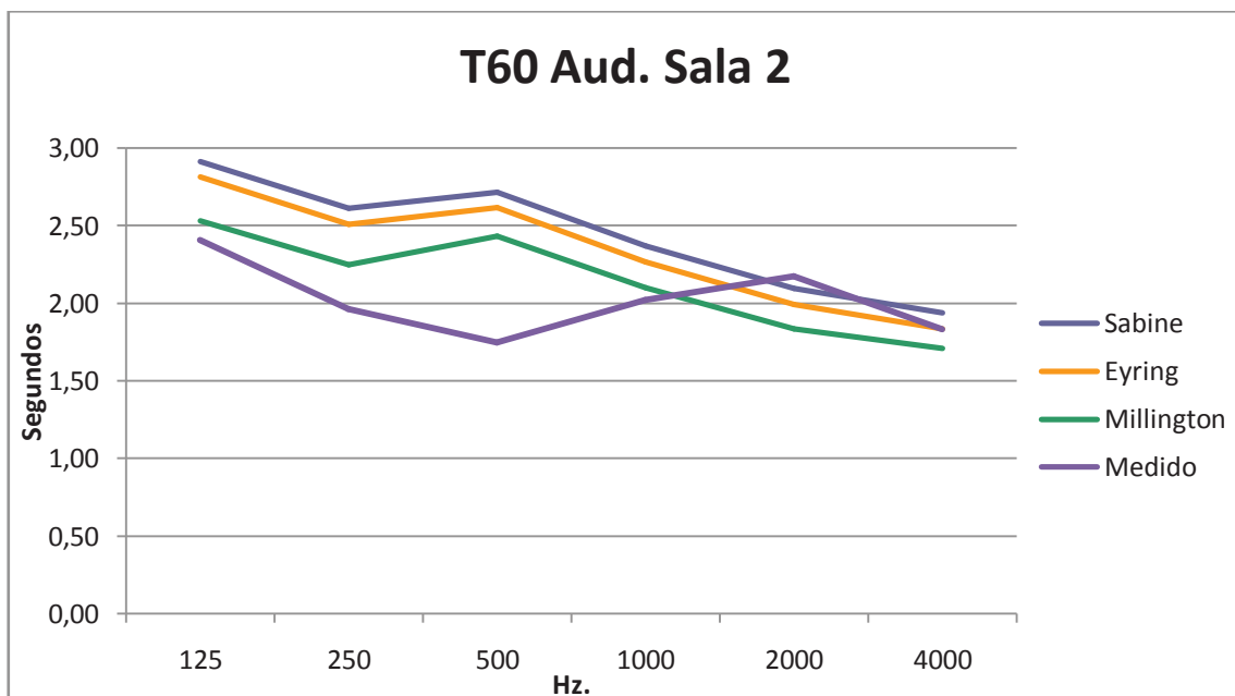
Figura 3.19 T60 calculado con los métodos Sabine, Eyring y Millington, en el auditorio sala 2.
