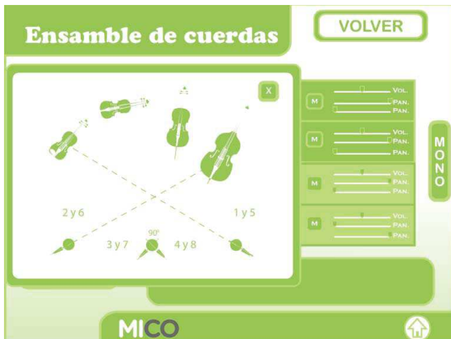
Fig. 8.21. Posicionamiento y distribución de instrumentos y micrófonos para el ensamble de cuerdas.
