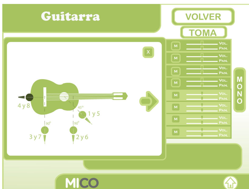
Fig. 8.22. Visualización del posicionamiento de micrófonos para la guitarra en la aplicación MICO.
