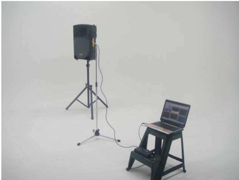
Gráfico 8.5 Medición según la norma de 1m de distancia desde la fuente hacia el micrófono y un NPS de 94dB. al final
