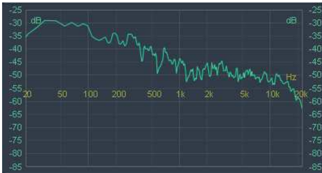
Fig.3.3 - Gráfico de frecuencia obtenido de la medición en el micrófono izquierdo al aire libre a 22,5°.
