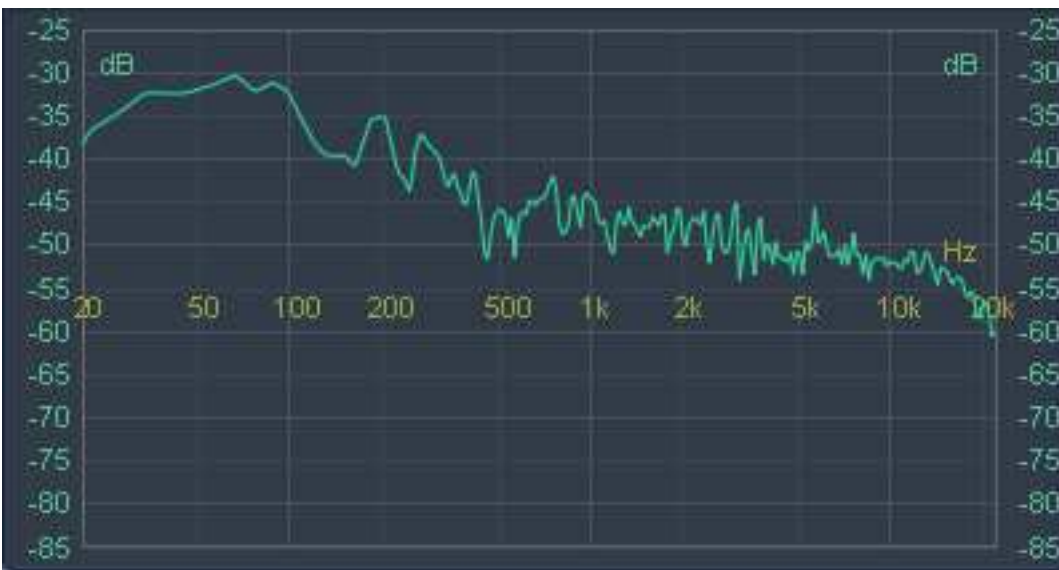
Fig.3.8 - Gráfico de frecuencia obtenido de la medición en el micrófono derecho al aire libre a 67,5°.
