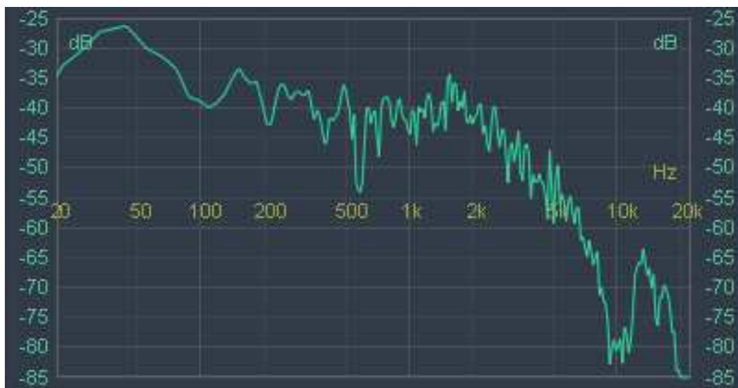
Fig.3.25 - Gráfico de frecuencia obtenido de la medición en el micrófono izquierdo dentro de la cabeza real a -67,5°.
