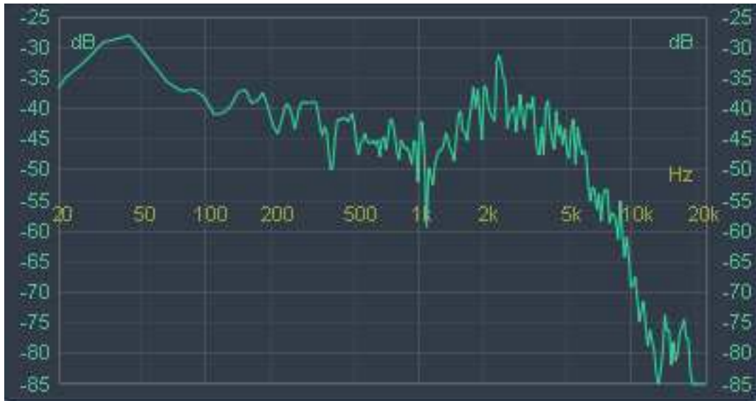
Fig.3.27 - Gráfico de frecuencia obtenido de la medición en el micrófono izquierdo dentro de la cabeza real a -90^\circ .
