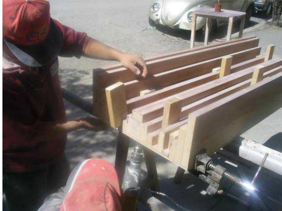
Figura 1.6. Ilustración de la elaboración de un panel difusor.
