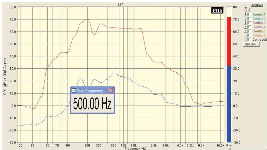
Figura 3.12 Medición Amplificador de Bajo Marca Freedom SED-35B (con instrumento).
