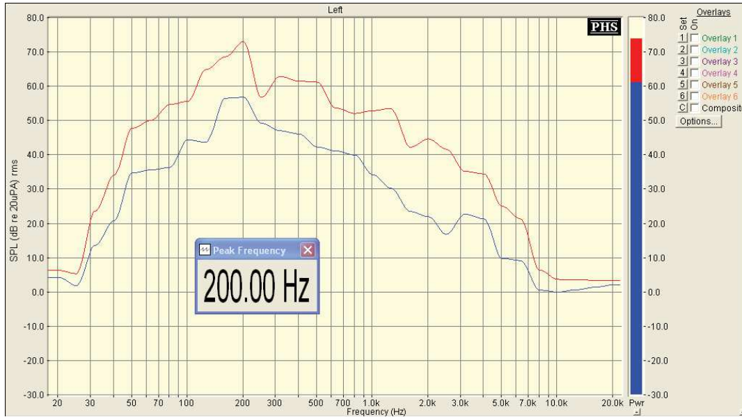
Figura 3.11 Medición Amplificador de Bajo Marca Marshall MB Series 15 (con instrumento).
