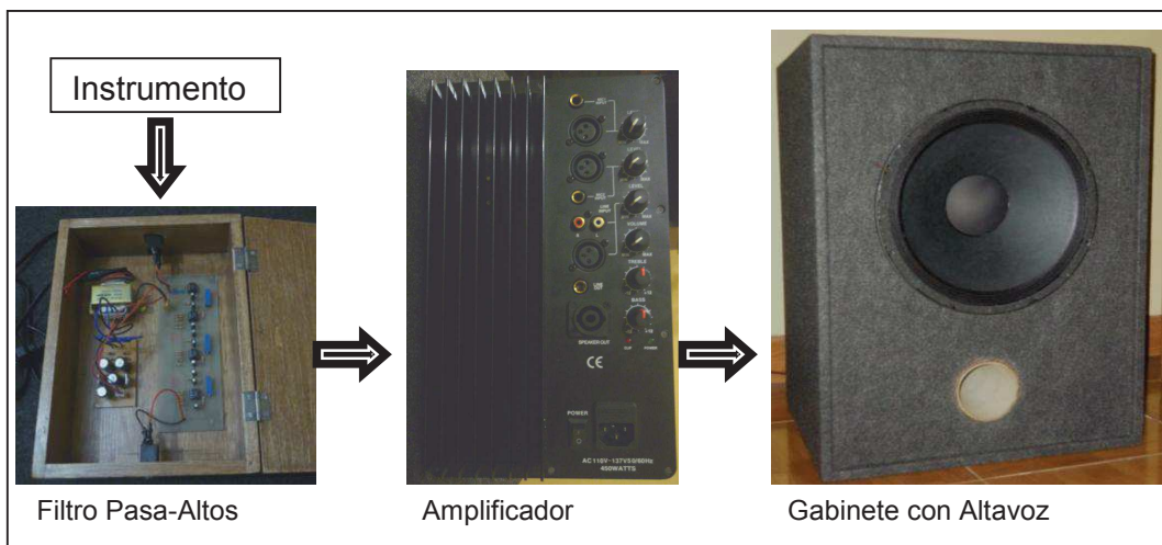
Figura 4.7 Esquema práctico de conexión entre todos los elementos.
