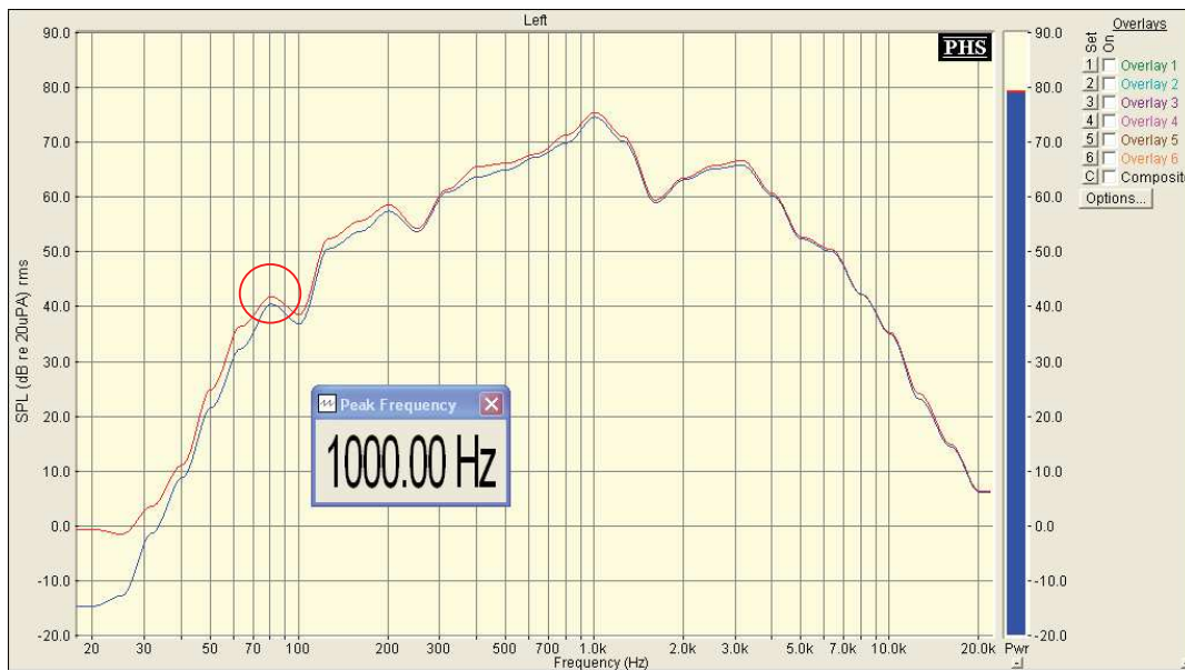
Figura 3.6 Medición Amplificador de Bajo Marca Freedom SED-35B
