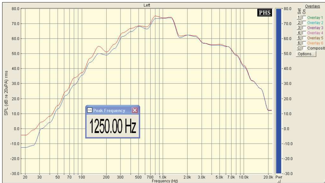
Figura 3.4 Medición Amplificador para Guitarra Marca Primer GA-158C
