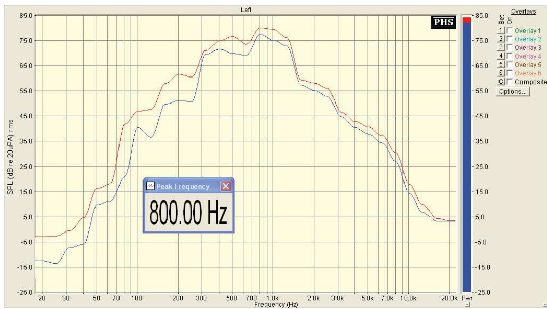
Figura 3.10 Medición Amplificador para Guitarra Marca Primer GA-158C (con instrumento).
