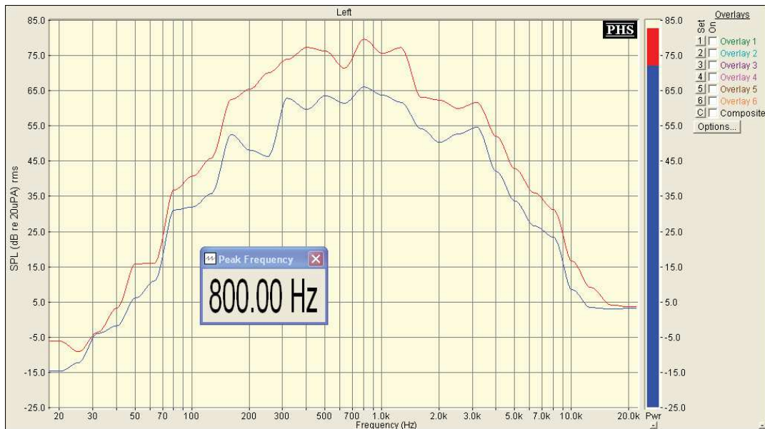
Figura 3.9 Medición Amplificador para Guitarra Marca Pers TEC-20G (con instrumento).
