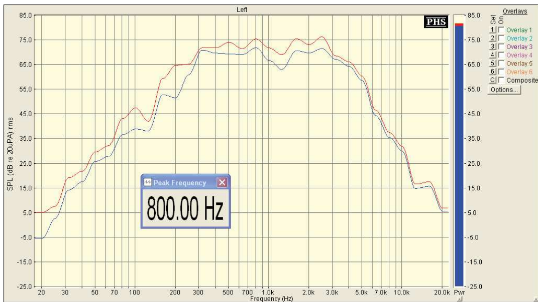
Figura 3.8 Medición Amplificador para Guitarra Marca Primer 10012R (con instrumento).
