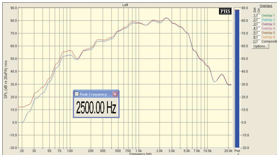
Figura 3.2 Medición Amplificador para Guitarra Marca Primer 10012R
