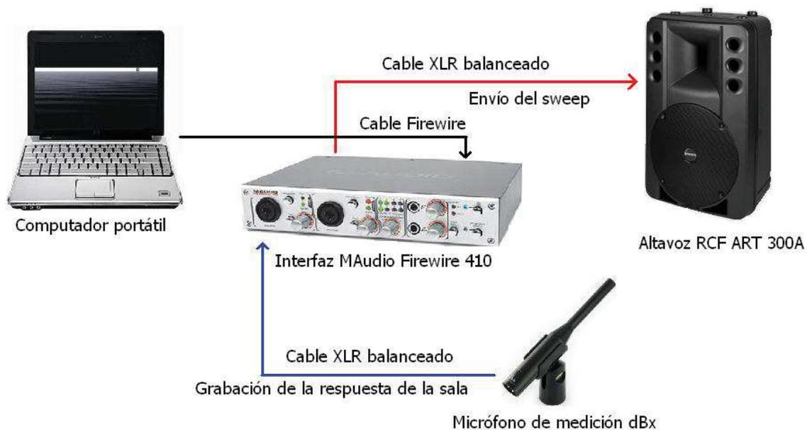
**Figura 4.9. - Esquema de conexiones de los elementos del sistema de medición.**
