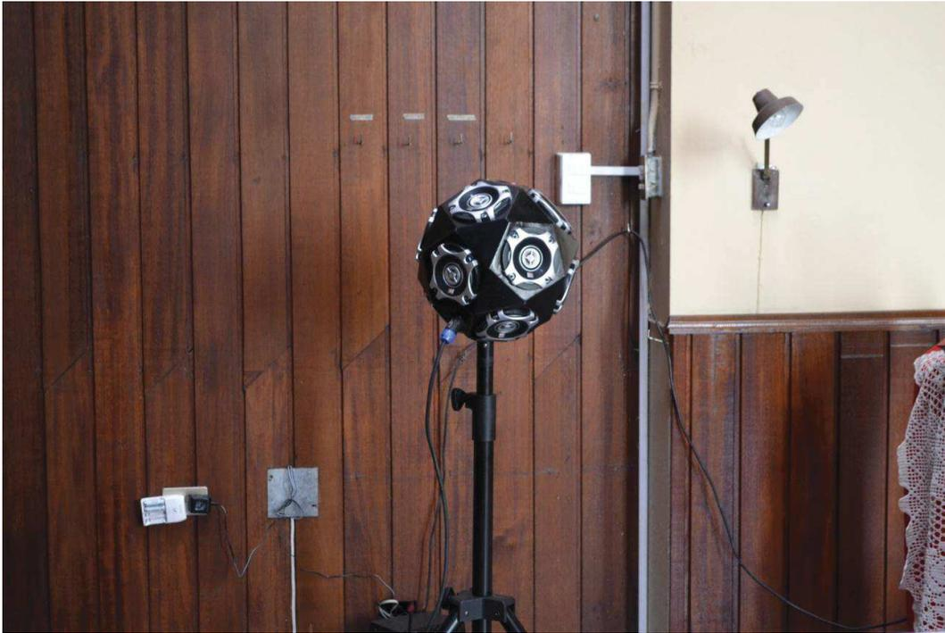
Fuente omnidireccional ubicada en un punto de medición
