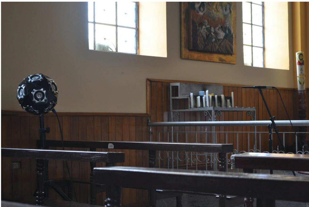
Micrófono utilizado en la medición
