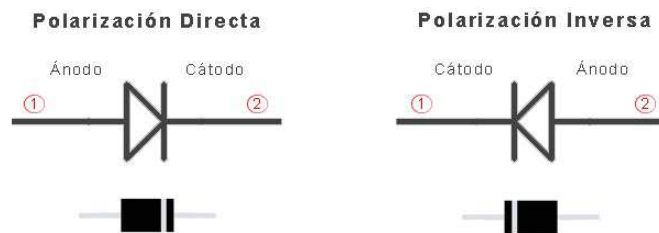
Figura 2.33 Polarización directa e inversa en el diodo. Se puede apreciar en la parte superior el símbolo del respectivo diodo y en la parte inferior la aproximada representación gráfica de su estructura externa
