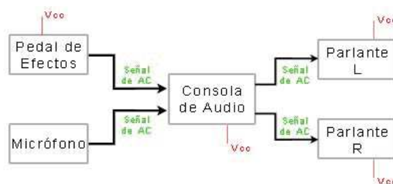
Figura 2.25 Esquema de señales AC y Voltajes DC (Vcc). Este es un ejemplo según la metodología conceptual de la tesis
