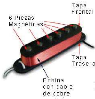
Figura 2.22 Anatomía básica de un pickup single coil
