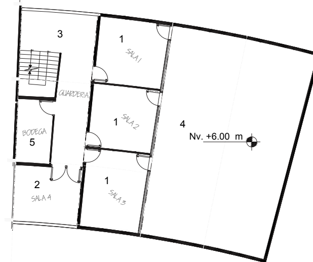
PLANTA TIPO AREAS COMUNALES GUARDERIA NIVEL +9,00 ESC 1:200
