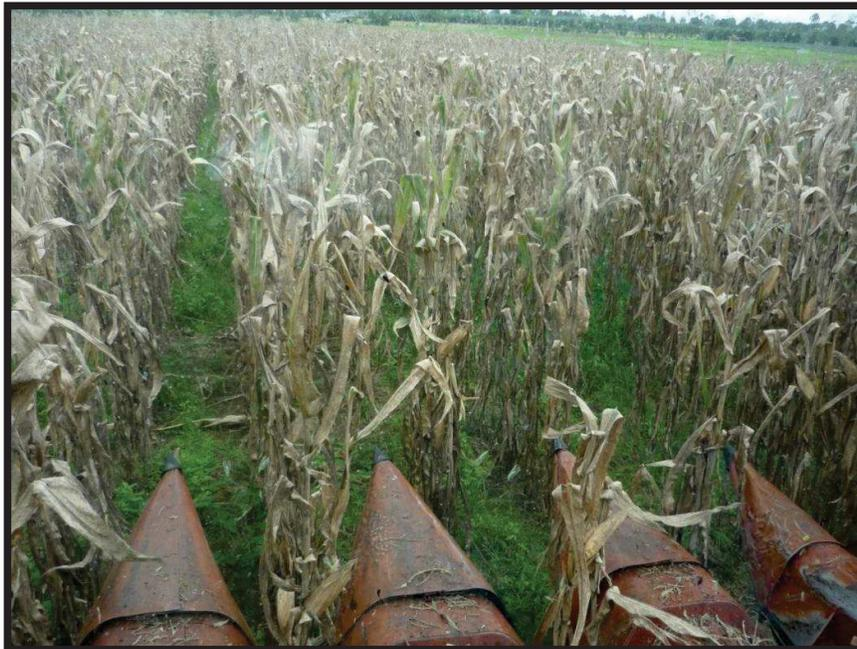
*Vista del cabezal de la cosechadora de maíz cortando la planta.*
