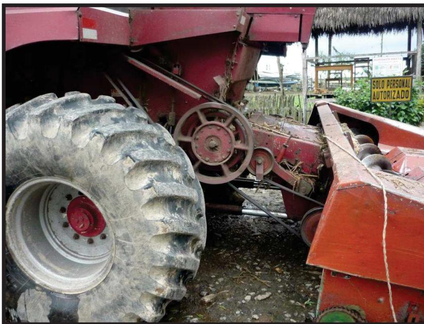
*Mecanismo de movimiento del cabezal de la cosechadora de maíz.*
