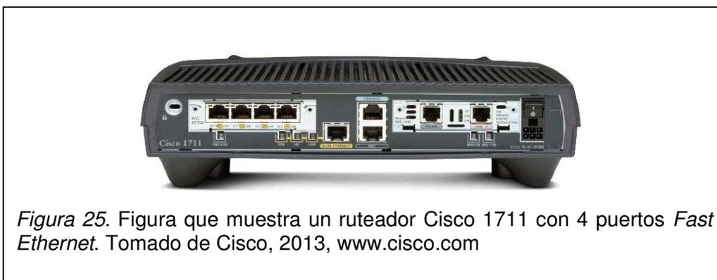
Figura 25. Figura que muestra un ruteador Cisco 1711 con 4 puertos *Fast Ethernet*. Tomado de Cisco, 2013, [www.cisco.com](http://www.cisco.com)
