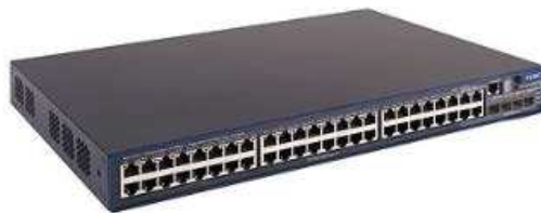
Figura 27 Switch HP A5500
