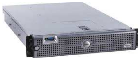
Figura 33 Servidor Dell power edge 2950 III
