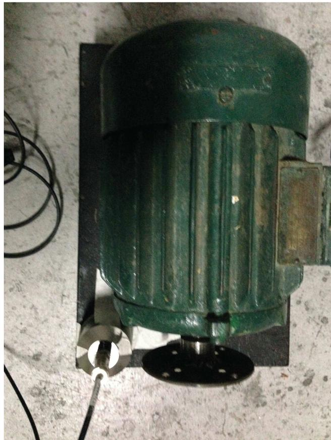
**Figura 6.2.** Vista superior del sistema y ubicación propuesta de acelerómetro.
