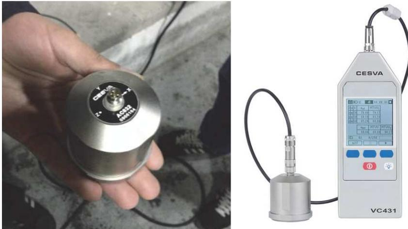
**Figura 5.1.** Vibrómetro y acelerómetro Cesva empleados.
