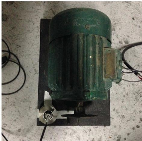
**Figura 5.8.** Detalle de la posición del acelerómetro
