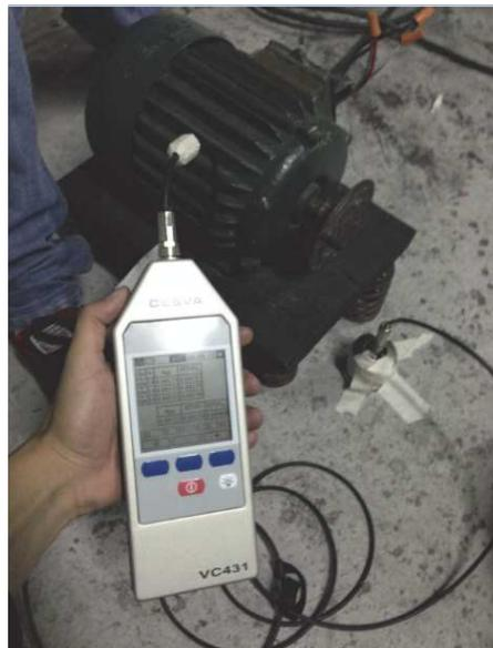
**Figura 5.10.** Medida 101 correspondiente al ruido de fondo con la fuerza impulsiva en la frecuencia de resonancia.
