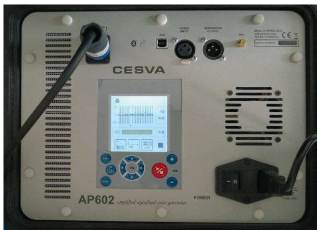
Figura 33. Amplificador para altavoz omnidireccional AP602
