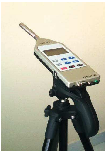
Figura 31. Sonómetro integrador clase 1 CESVA SC310
