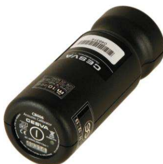
Figura 34. Calibrador CESVA CB006
