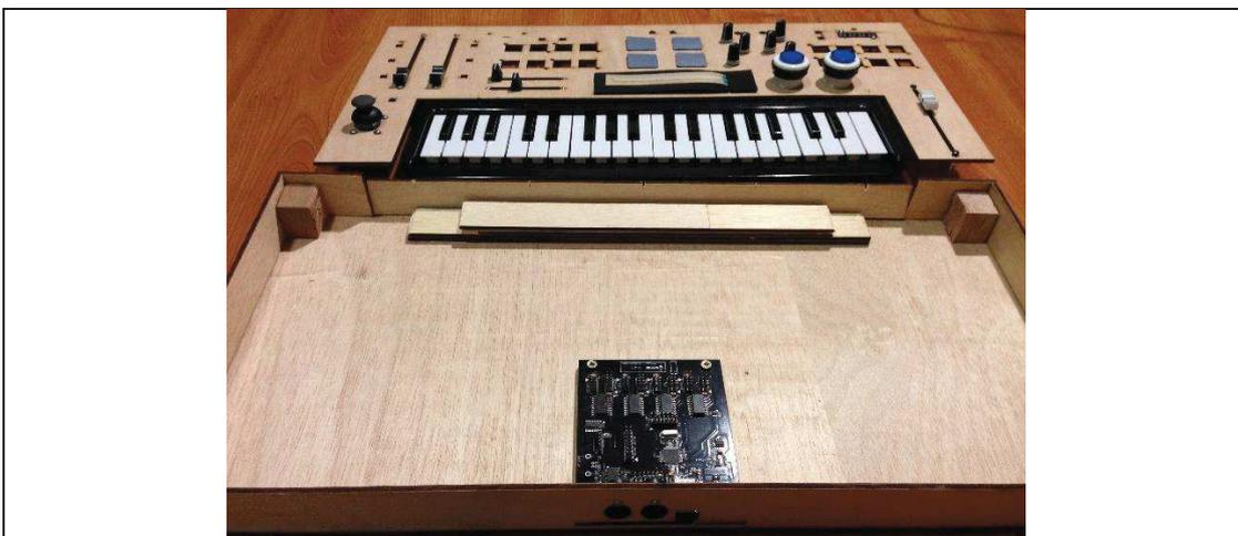
*Figura 23.* Compartimiento y panel frontal fabricados en madera.
