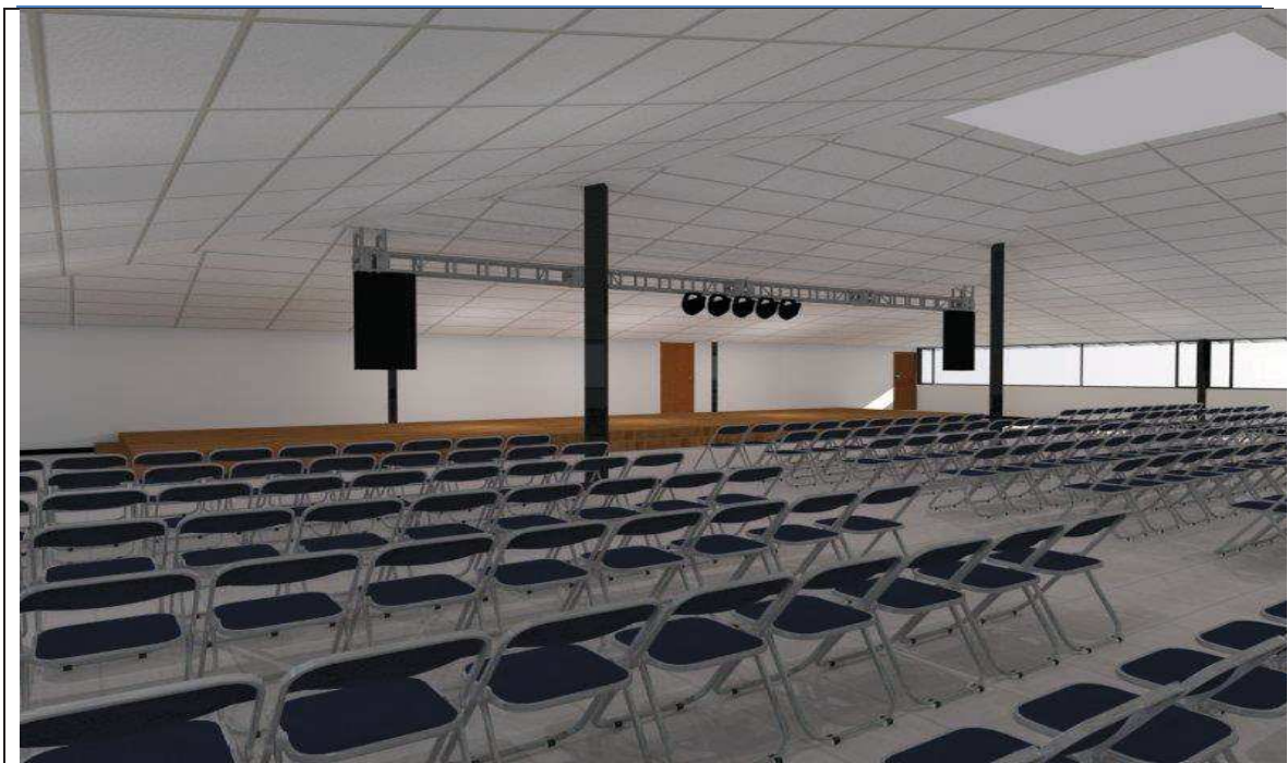
Vista del sistema NEXO line array para el auditorio del Colegio de Liga con su respectiva estructura metálica.
