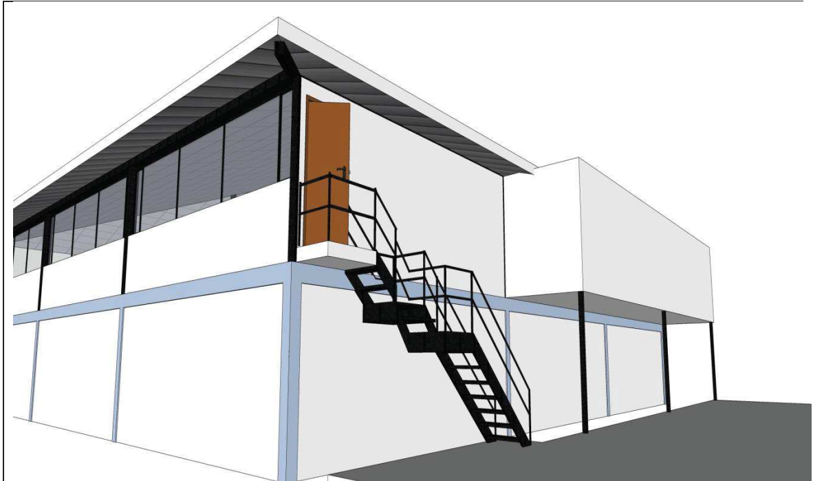
Vista exterior del camerino y la nueva ubicación de las gradas y la puerta de emergencia.
