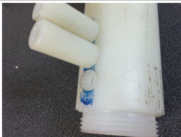
Figura 131. Acople de portamuestras a tubo principal
