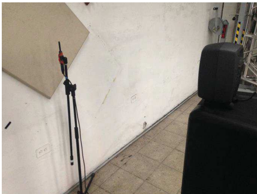
Figura 102. Medición in situ panel acústico
