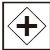
**Figura 18. Compuerta Paralela. Adaptado de OMG, 2011.**
