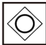
**Figura 19. Compuerta Inclusiva. Adaptado de OMG, 2011.**
