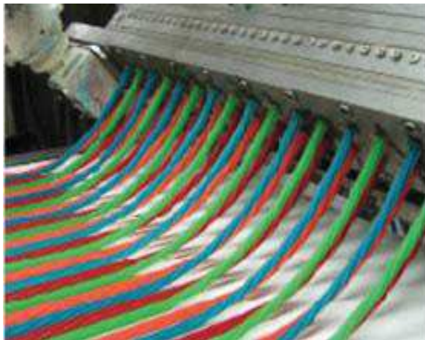
Figura 41. Ejemplo de cordones de chicle saliendo de la extrusión inicial. Tomado de Quiminet
