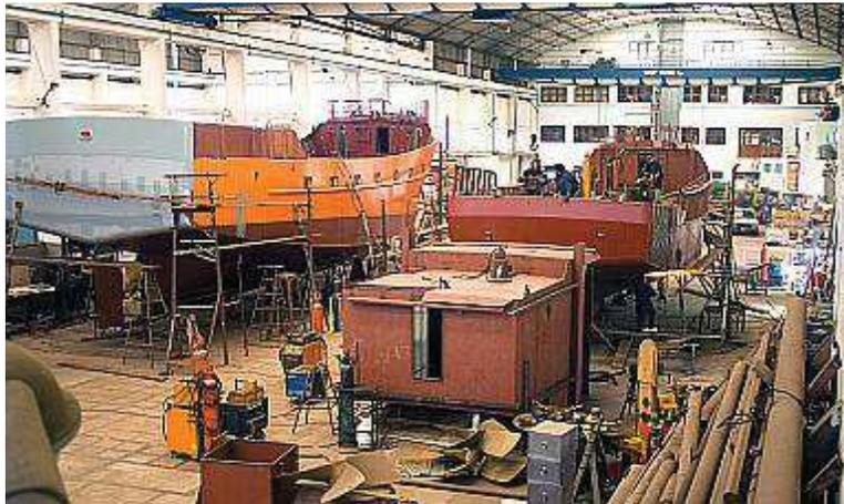
*Figura 18.* Distribución en planta por posición fija de una empresa fabricante de barcos pesqueros.
