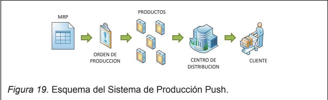
Figura 19. Esquema del Sistema de Producción Push.
