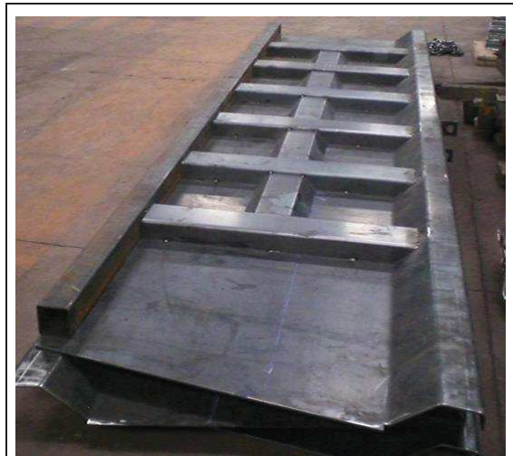
Figura 9. Costado lateral de la tolva (8m 3 )
