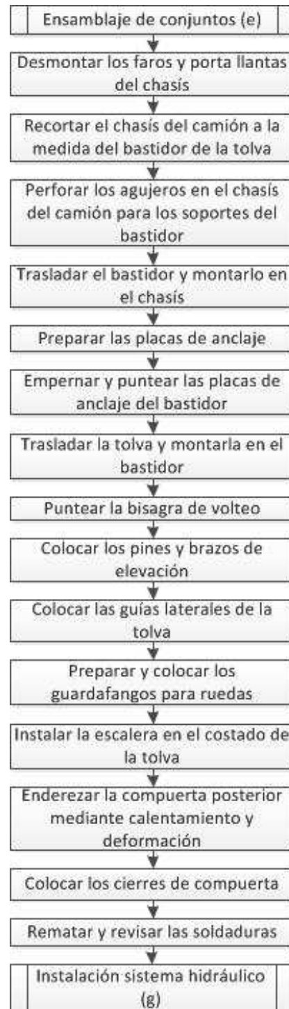
Figura 17. Flujograma de actividades para el montaje de la tolva en el chasis del camión.
