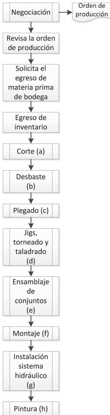
Figura 15. Flujograma de procesos para la fabricación de la tolva de volteo Adaptado de Industrias I.V.E., 2013
