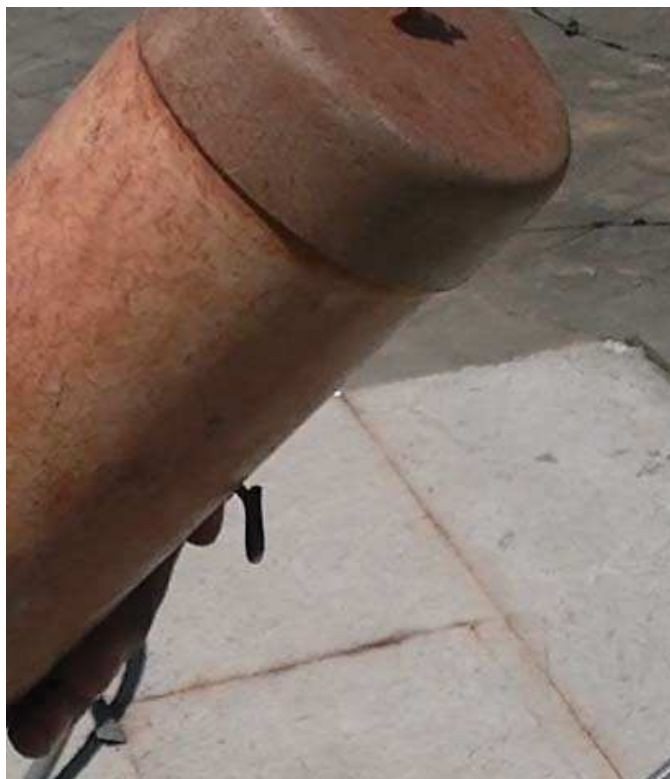
Figura 4. Timbre de Caoba se utiliza en el área de la construcción para determinar el sitio donde se va a colocar las diferentes estructuras. Adaptado de: La Organización Ecapro, 2011.
