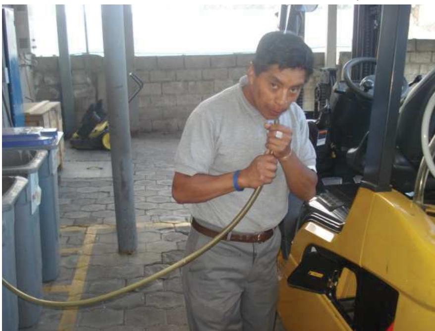
Foto N° 3.14 “Proceso de llenado de tanque del Montacargas”
