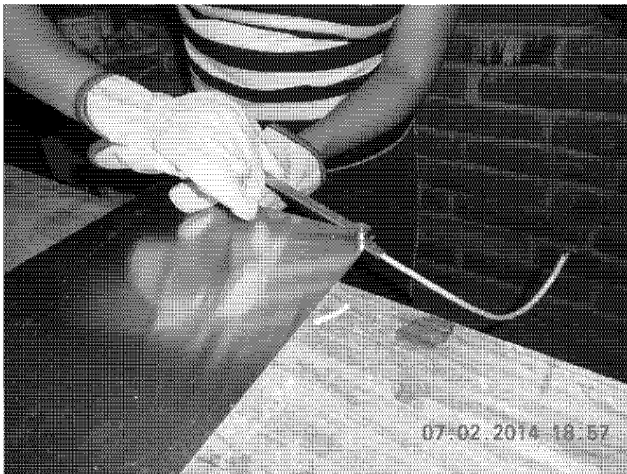
Colocación de terminales de ojo y tornillos en las placas.
