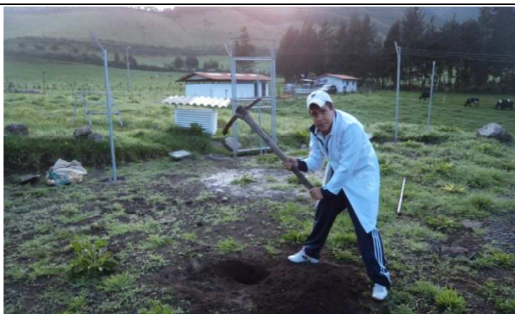
Figura 8. Técnica de medición de temperatura del suelo desarrollada en Nono, cavando un hueco a 30 centímetros de profundidad.
