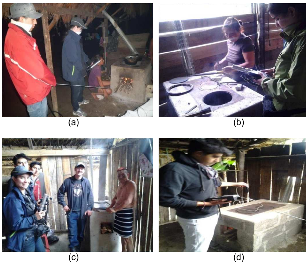
Figura 18. Tercer monitoreo atmosférico realizado en la comunidad de El Poste. Explicación: (a) Monitoreo de cocina mejorada ubicada al exterior de la vivienda, (b) uso del MICRODUST pro para las mediciones de PM (c) equipo de monitoreo con cocina mejorada ubicada al interior de la vivienda y, (d) manipulación del MX6 iBrid para la toma de datos de CO.
