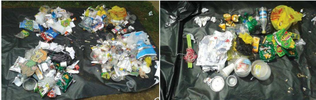
*Figura 8. Método de cuarteo y separación de materiales*
