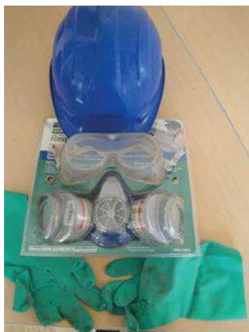
Figura 26. Equipo de seguridad para fumigación
