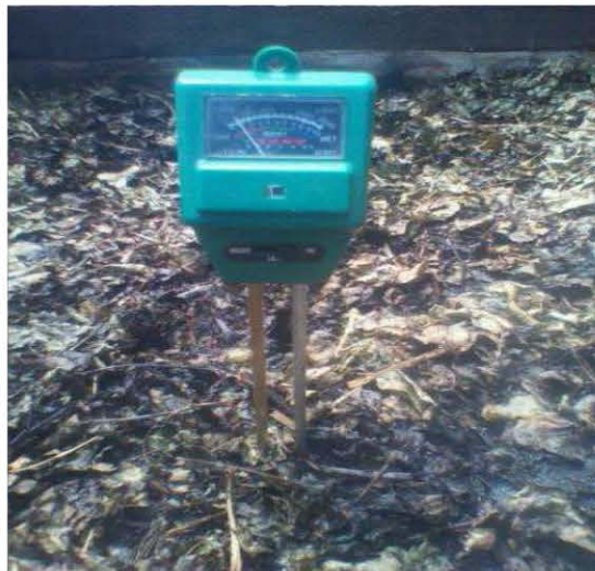
Figura 14: Medición del pH en los lechos de compostaje
