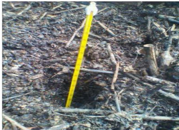
Figura 13: Medición de la temperatura en los lechos de compostaje.
