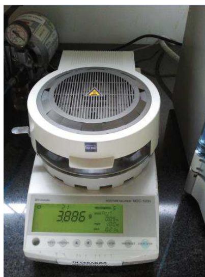
Figura 52. Desecador infrarrojo Marca Shimadzu, Cap max de 120 g.
