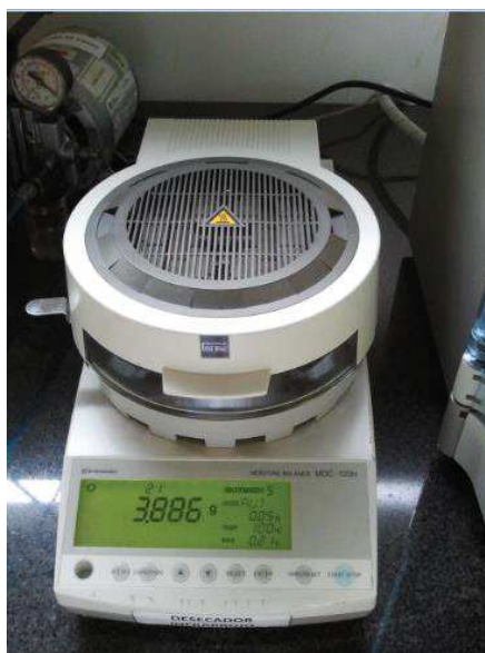
Figura 41. Control de humedad Marca Shimadzu, Cap max de 120 g.
