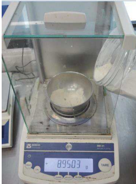
Figura 42. Pesaje de materia prima Marca Shimadzu, Cap max de 220 g.
