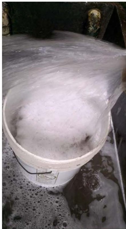
Figura 20. Recepción de caudal en balde aforado
