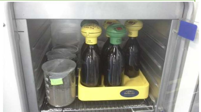
Equipo de  $DBO_5$  dentro del horno de incubación.
