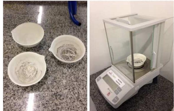
Cápsulas de porcelana con muestras de sólidos; pesaje de las cápsulas.
