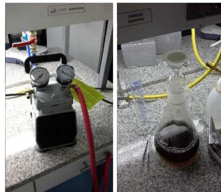
Equipo de filtración con bomba de vacío.
