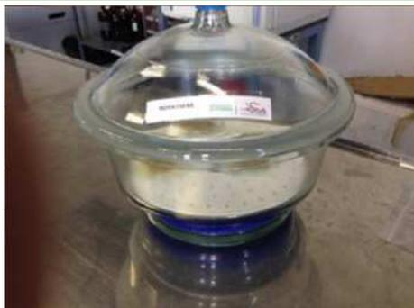
Desecador con los filtros del ensayo de sólidos suspendidos.
