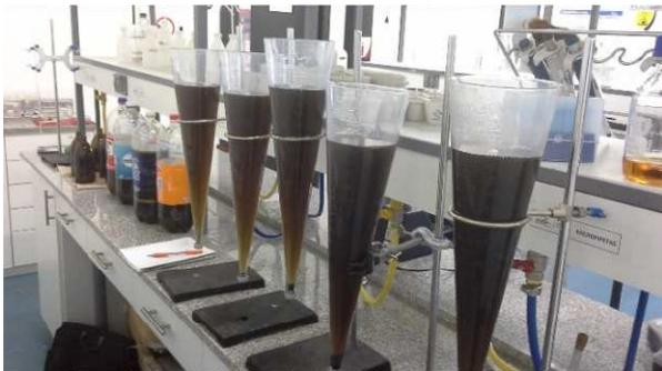
Conos Imhoff para el ensayo de sólidos sedimentables.
