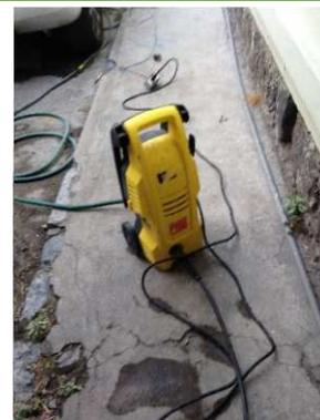
Hidralavadora a presión para limpieza de los tanques.
