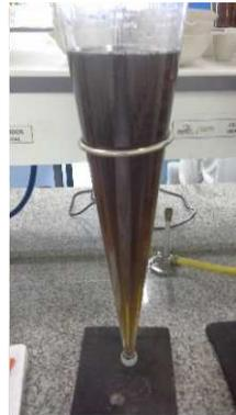
Conos Imhoff para el ensayo de sólidos sedimentables.
