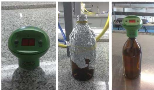
Botellas de incubación ambar y equipo de OxiTop para la medición de  $DBO_5$ .
