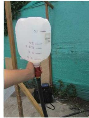
Calibración del caudal de salida de la bomba.
