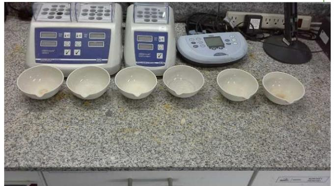
Cápsulas de porcelana para el ensayo de sólidos totales.
