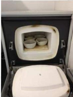
Mufla con las muestras para el ensayo de fracción fija y volátil
