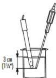
Figura 4: Medición de pH y Temperatura
