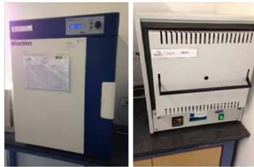
Equipos de estufa y mufla empleados en los ensayos de sólidos suspendidos, totales, fracción fija y volátil.
