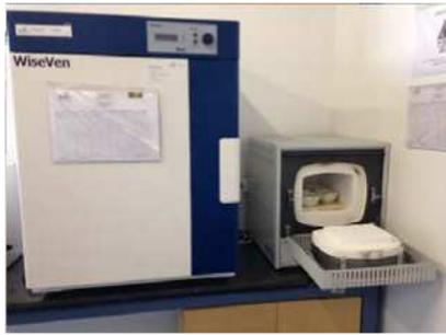
Equipos de estufa y mufla empleados en los ensayos de sólidos suspendidos, totales, fracción fija y volátil.
