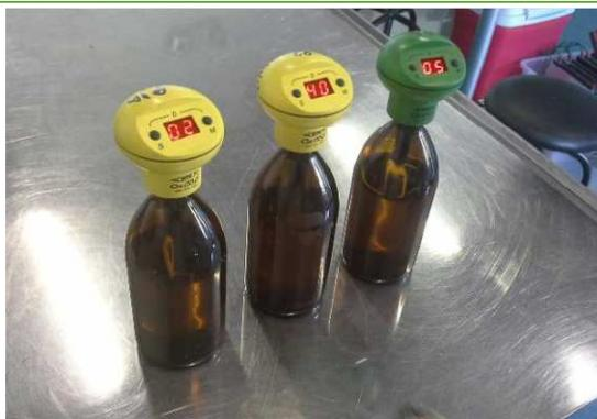
Toma de los datos de medición del  $DBO_5$ .
