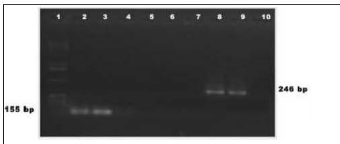
Figura 7. Identificación fragmento del gen \gamma -conglutina por PCR de la V1 INIAP 450 Andino de L. mutabilis .
