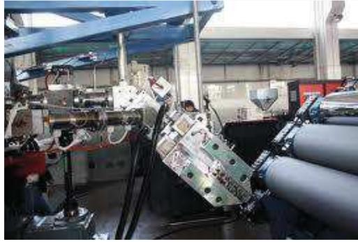
Figura 14. Cabezal de película plana y unidad de rodillo para coextrusión o extrusión simple. Tomado de Quantum, 1991, pp. 37.
