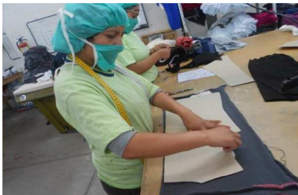
Figura N° 39: Colocación de los patrones
