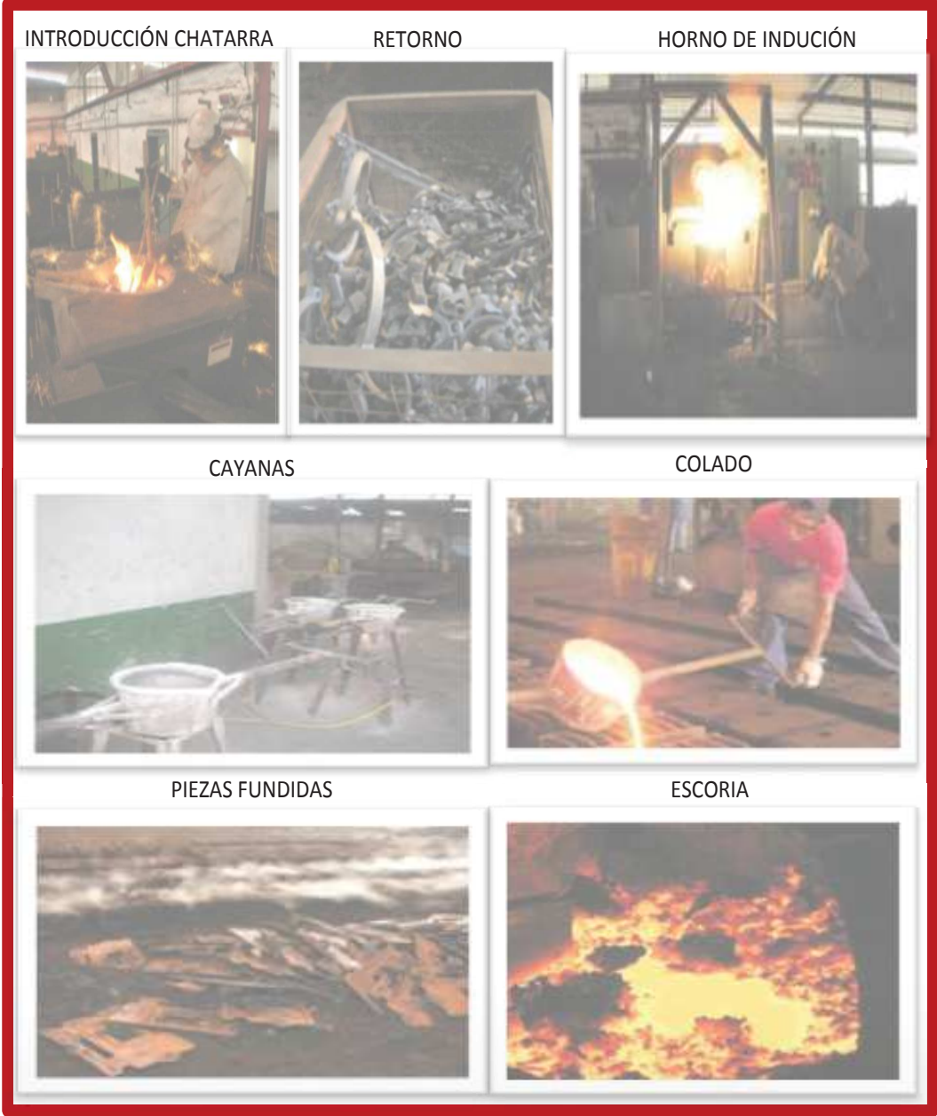
Ilustración 3.7: Proceso de fusión
