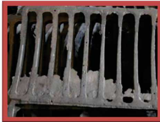
Ilustración 3.16: Exceso de rebaba
