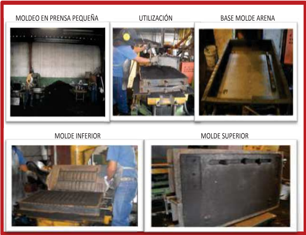
Ilustración 3.4: Proceso de moldeo
