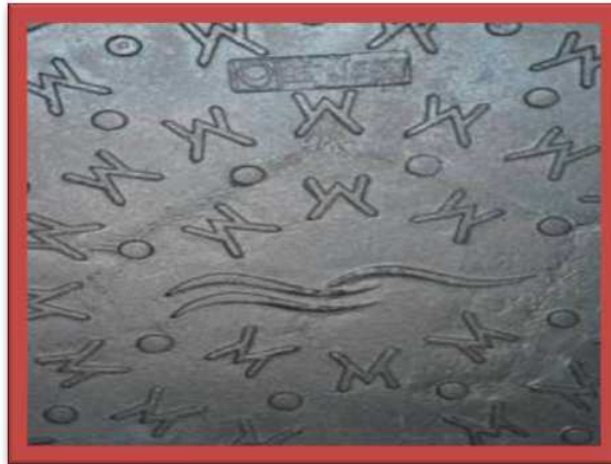
Ilustración 3.10: Pieza con rechupe
