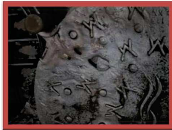
Ilustración 3.14: Pieza con sopladura
