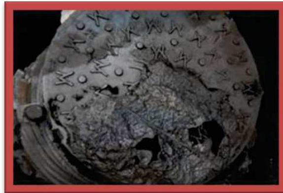
Ilustración 3.12: Molde mal cargado
