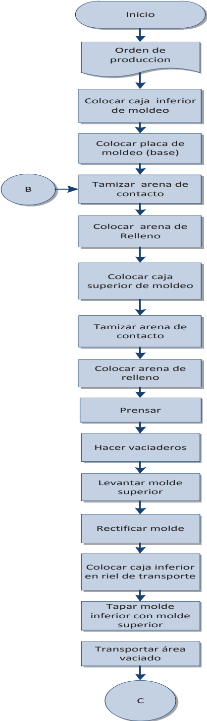
Diagrama 3.3: Proceso de moldeo
