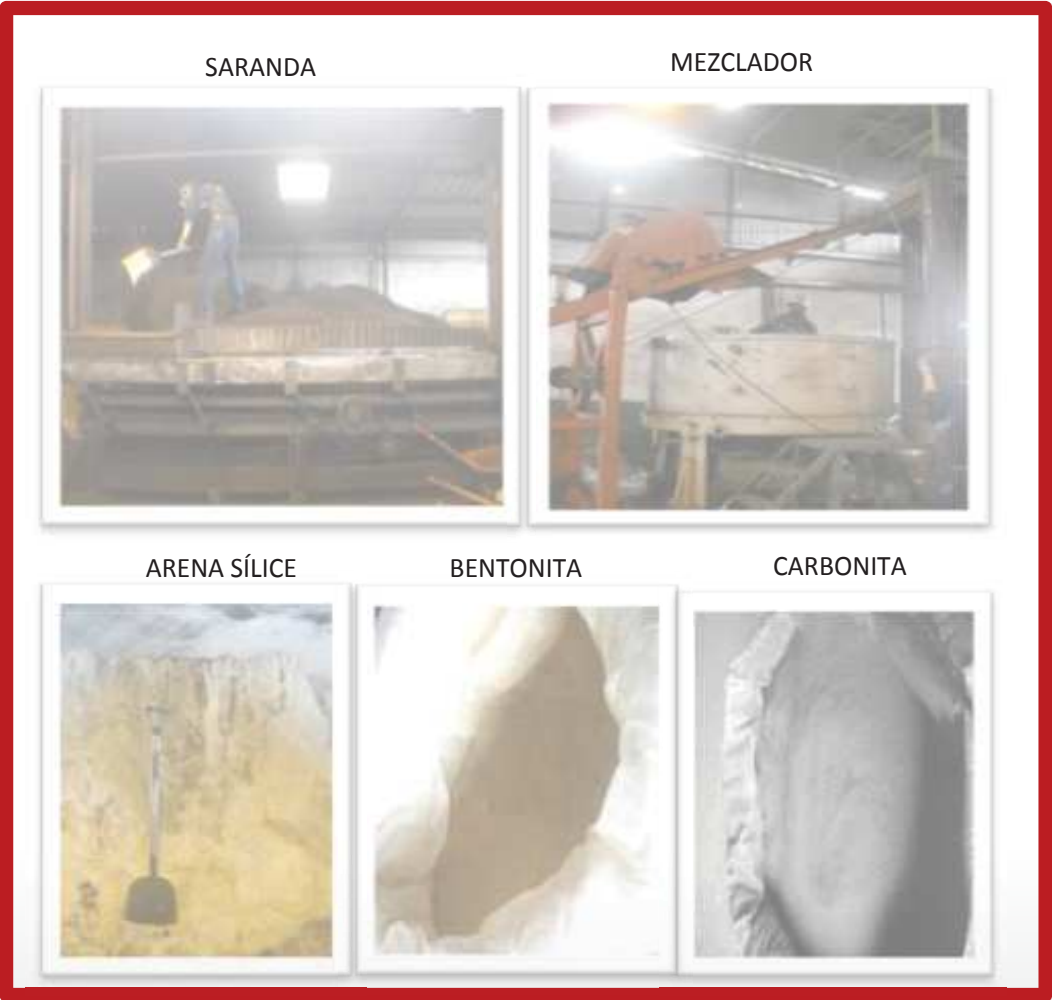
Ilustración 3.3: Proceso y materiales preparación de la arena
