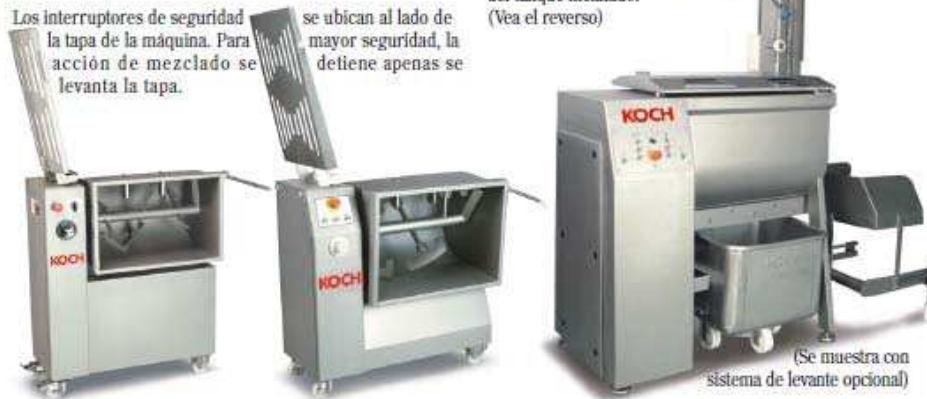
KFM-110 Mezcladora de 110 lb de capacidad
