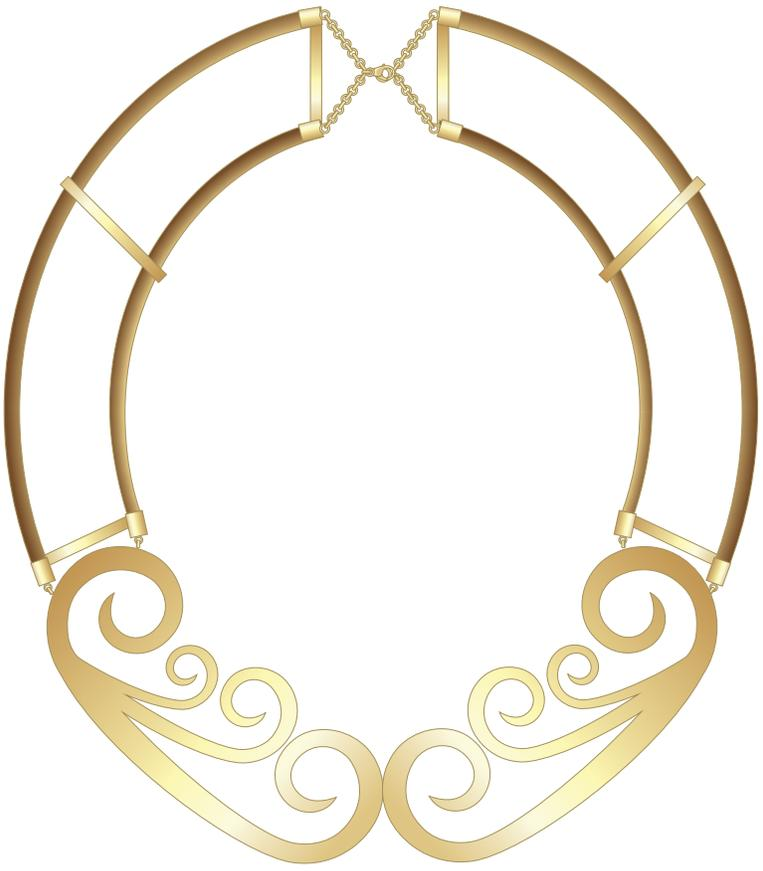
Observaciones: Oro: Ancho de chapa 0.6 (calibrador de compás). Tapa cuero de tubo y separador de cuero
