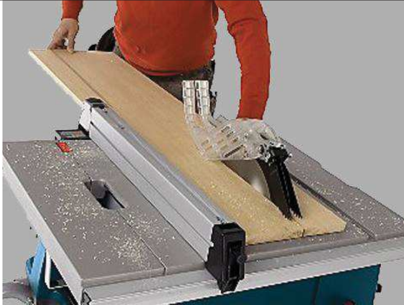
Figura 97. Corte en sierra de banco bosch
